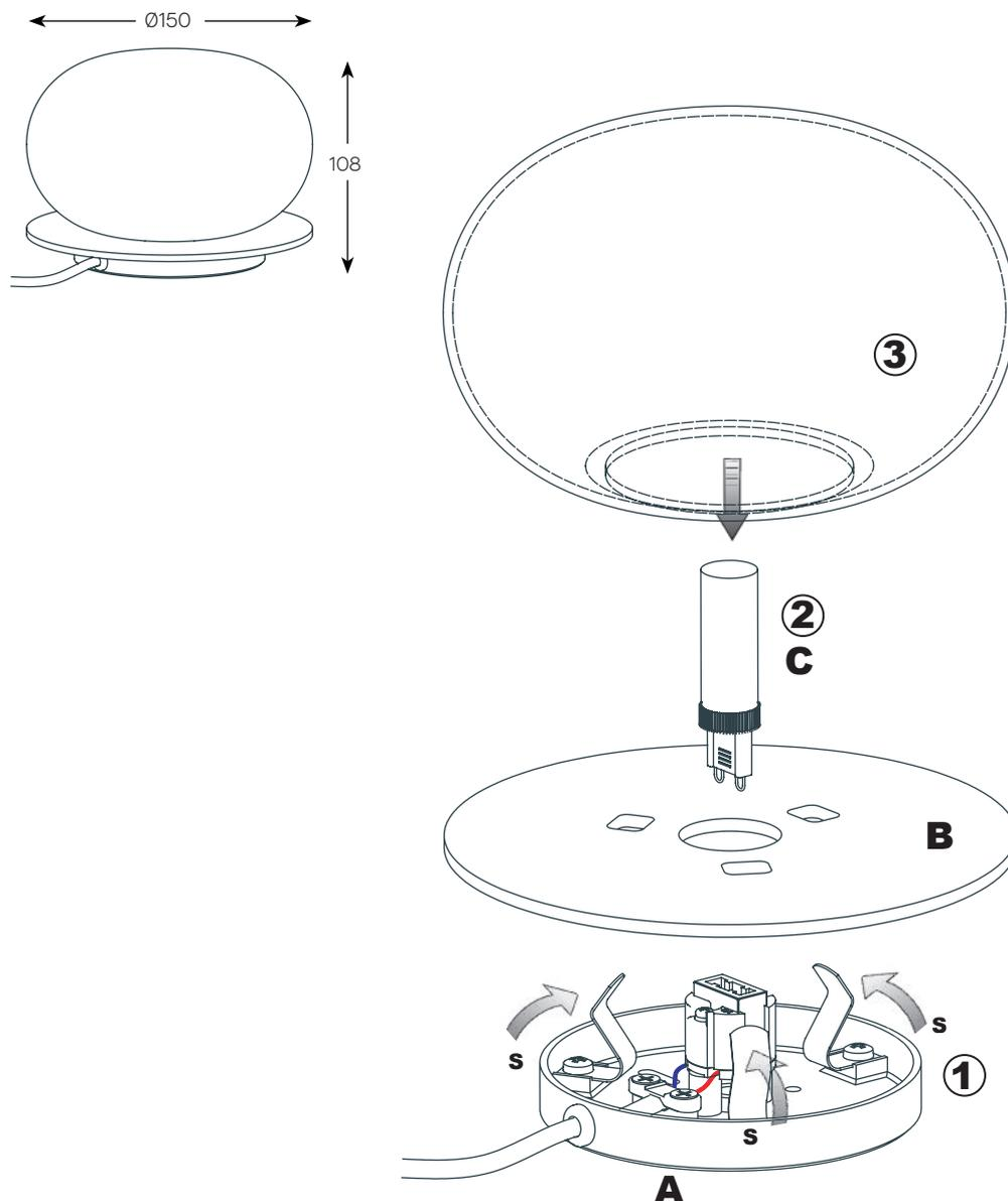
**1** Colocar la pantalla ( B ), encarando sus tres agujeros rectangulares con los muelles fijados en la base ( A ). Presionar ligeramente la pantalla ( B ), hasta que los muelles queden fijados en la misma, sobresaliendo parte de los mismos.
